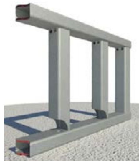
Foto 2 - afbeelding van zichtbare verzinkgaten aan de bovenzijde en niet zichtbare verzinkgaten aan de onderzijde van de kokerspijl
