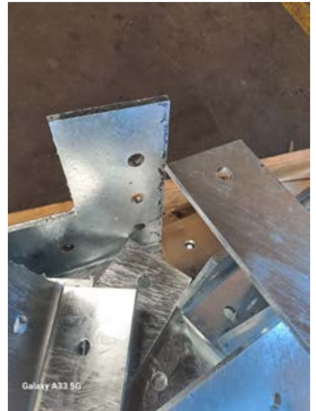
Foto van MC staal dat onverzinkte plekken vertoonde vanwege oxidevorming veroorzaakt door thermisch snijden.
