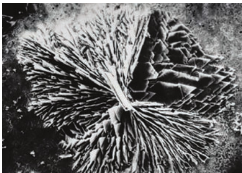
CaHZn kristallen na 24 uur in \text{Ca}(\text{OH})_2 oplossing van pH 12,6
