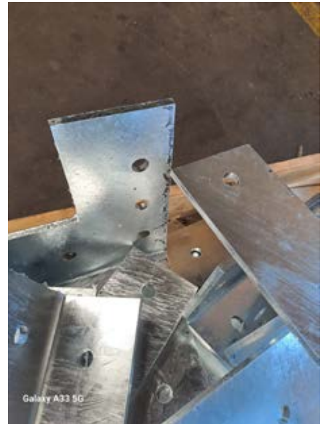
Foto van MC staal dat onverzinkte plekken vertoont vanwege oxidevorming veroorzaakt door thermisch snijden.
