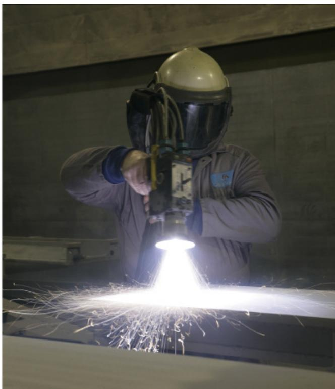
Notez bien que ce procédé nécessite l'application d'un revêtement organique en raison de la porosité élevée associée au zingage par projection thermique. Il nécessite aussi un contrôle de processus approfondi, avec notamment un contrôle précis de la température et du taux d'humidité, ainsi que du temps entre la projection thermique et l'application du revêtement organique.
