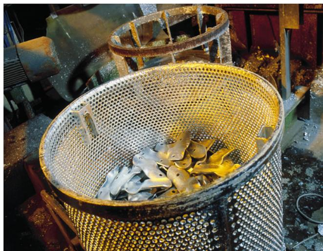
Après avoir été prêtaitées, les pièces sont galvanisées dans des paniers. Ces paniers sont placés dans une centrifuge en sortie du bain de zinc. Cette centrifuge essore le zinc qui n'a pas réagi. La couche de zinc obtenue est donc un peu plus fine que dans le cas du procédé discontinu de galvanisation à chaud.
