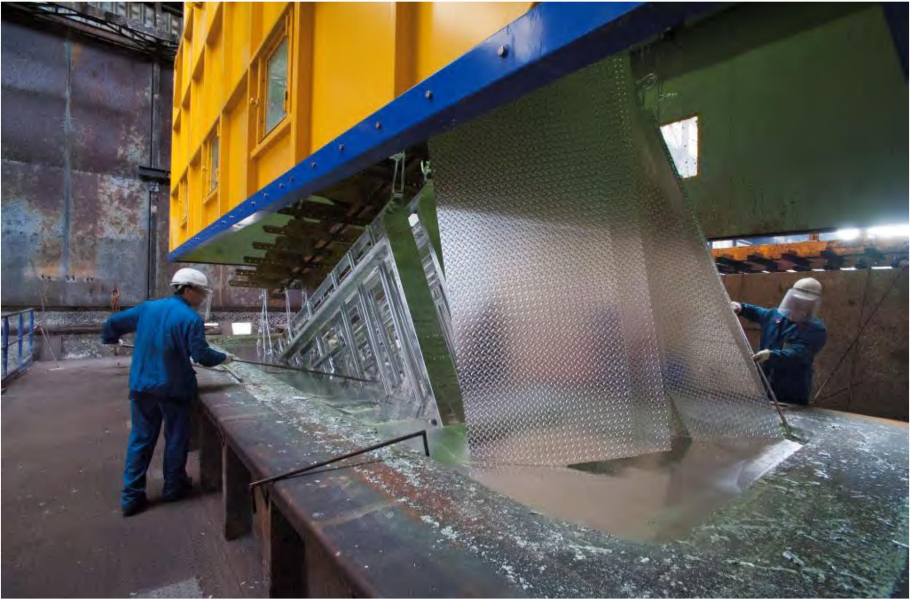
*La galvanisation à chaud augmente le poids de l'acier noir (= non galvanisé) d'un pourcentage généralement compris entre 3 et 12 %. L'augmentation du poids est déterminée par la combinaison d'une série de facteurs, dont les suivants :*
