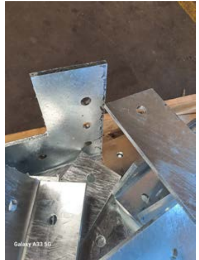
Photo d'un acier MC montrant des taches non galvanisées dues à la formation d'oxyde causée par le découpage thermique.
