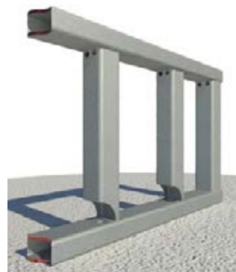
Photo 2 - illustration des trous visibles en haut et des trous non visibles en bas de la barre tubulaire
